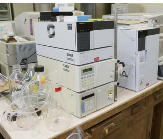
◀抗酸化性ペプチドの分離に用いた高速液体クロマトグラフィー
