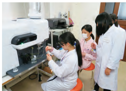
サイエンスキャンプに参加した高校生が、本機器を用いて毛髪中の亜鉛濃度を測定している様子
